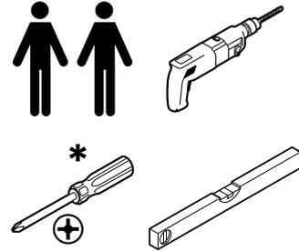
\* **VORSICHT:** Bei Verwendung eines Akkuschraubers (nicht empfohlen) möglichst niedrige Drehmomentsstufe wählen!
